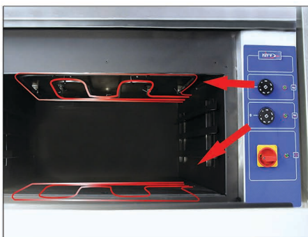
■ Раздельная регулировка ТЭНов. Два термодатчика обеспечивают раздельное регулирование верхнего и нижнего ТЭНов.
